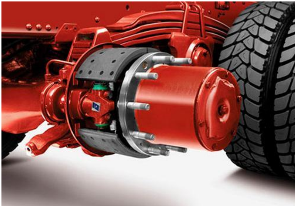
Рис.7.4. Пневматичний барабанний гальмівний вузол у зборі на автомобілі
