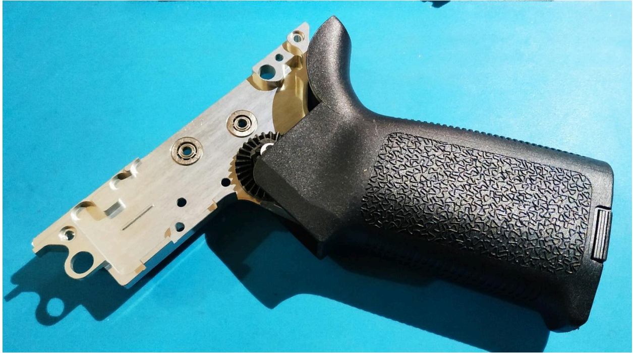
Mặt trên Gearbox và Bevel Gear được gắn vào Grip
