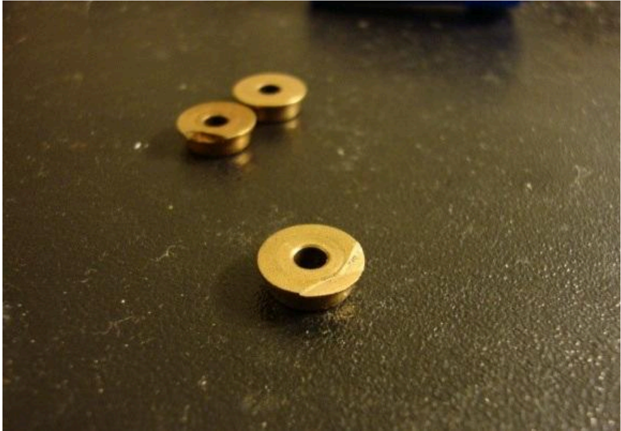
Hình ảnh Bushing bị hỏng do shim lỗi
