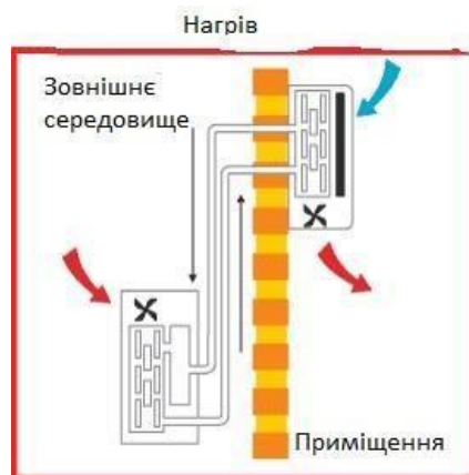
Рисунок 7.3 – Робота кондиціонера в режимі обігріву
