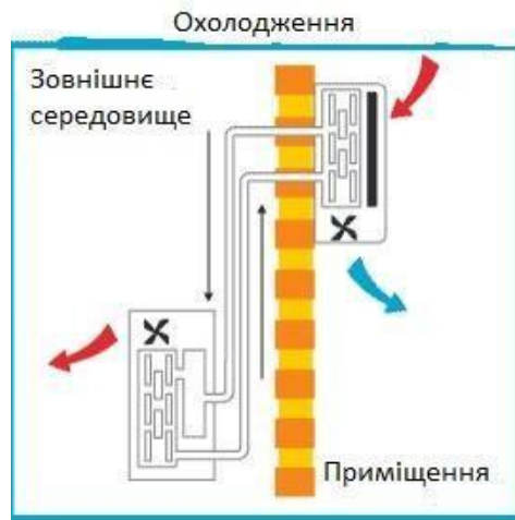
Рисунок 7.2 – Робота кондиціонера в режимі охолодження
