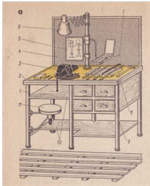
Мал. 2.1. Слюсарні верстаки з поворотними лещатами: а – одномісний, б – багатомісний; 1 – каркас, 2 – столешниця, 3 – лещата, 4 – захисний екран, 5 – планшет для креслень, 6 – світильник, 7 – поличка для інструментів, 8 – планшет для робочого інструмента, 9 – ящики, 10 – полички, 11 – сидіння.
