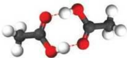
Рис. 33. Схема утворення димерів етанової кислоти
