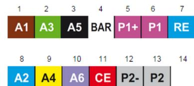
**Hinweis!** Werden 2-Draht PT 1000 Sensoren verwendet, wird jeweils P1+ mit P1 und P2- mit P2 verbunden.
