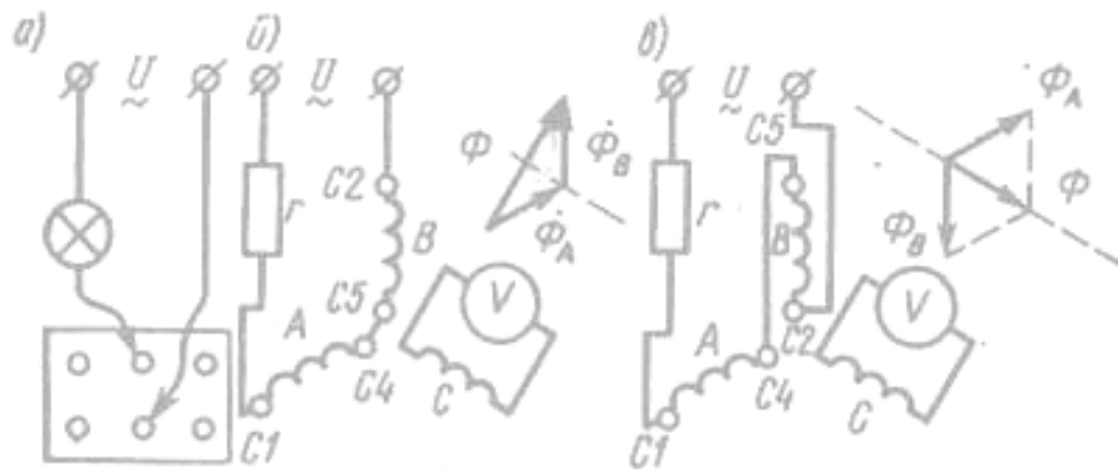
Рис.1. Схеми для визначення виводів («початок» і «кінець») фазних обмоток статора асинхронного двигуна
