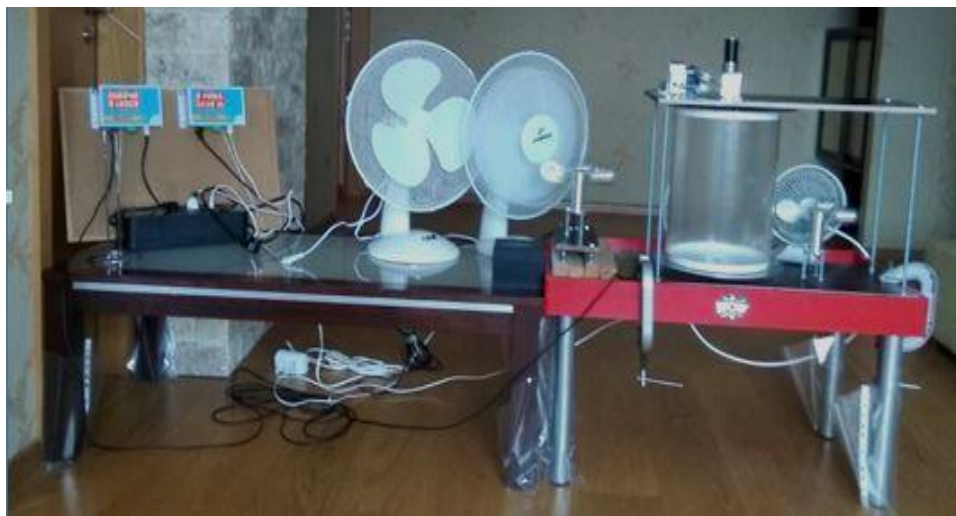
Фото экспериментальной установки для определения степени ускорения ветра перед турбиной вращающимся круговым цилиндром.
