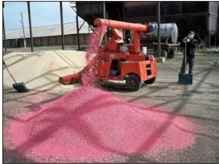
Рис. 7.1 Загальний вигляд протруювача ПС-10А
