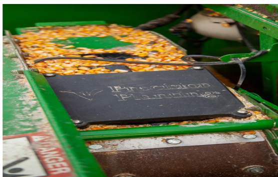
Рисунок 6. Датчик врожайності, встановлений на комбайні
