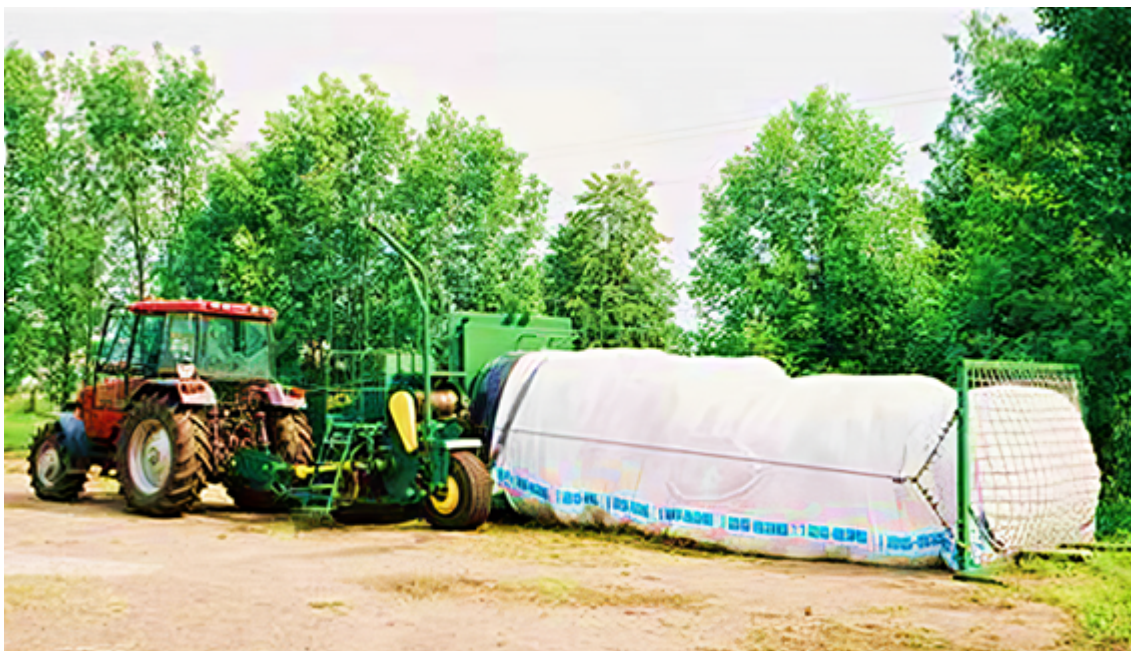
Рис. 5.1.8. Укладач силосно-сінажної маси УСМ-1
