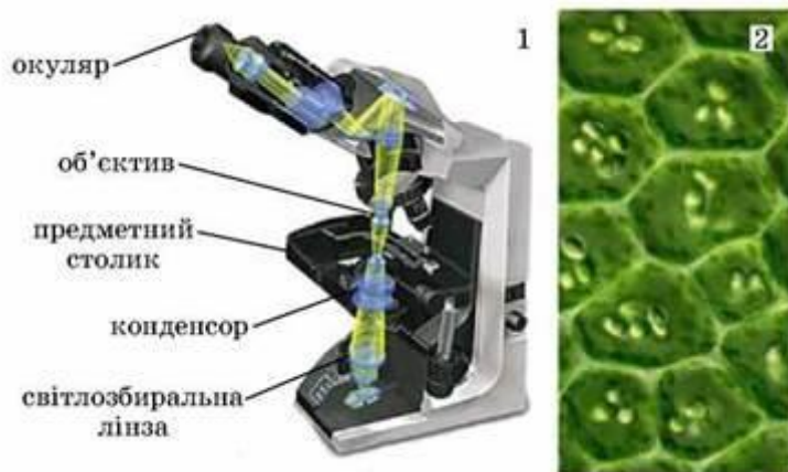
Мал. 37. 1. Схематична будова і принцип роботи світлового мікроскопа. Завдання. Зверніть увагу на хід променів світла від його джерела до системи лінз об'єктива та окуляра. 2. Клітини рослини у полі зору світлового мікроскопа
