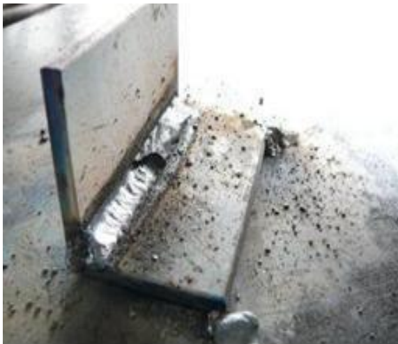
а, б – плоских деталей; в – циліндричних деталей Рисунок 37 – Зовнішній вигляд деталей з'єднаних зварюванням
