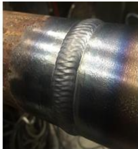
а, б – плоских деталей; в – циліндричних деталей Рисунок 37 – Зовнішній вигляд деталей з'єднаних зварюванням
