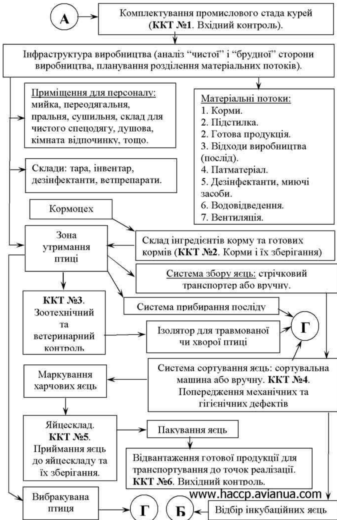
Рис. 2. Блок-схема виробничих процесів цеху утримання дорослої птиці і ККТ моніторингу факторів, що впливають на безпечність продукції згідно принципів системи НАССР.
