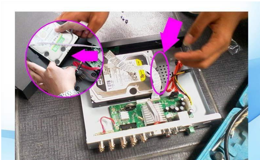
Hình 2.10 Gắn ổ cứng HDD vào đầu ghi. Kết nối cáp tín hiệu Sata & cáp nguồn
