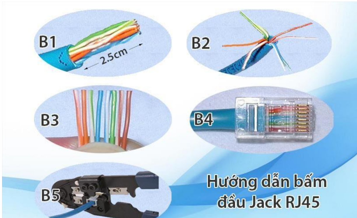
Hình 2.15 Cách bấm đầu cáp RJ45 cho camera
