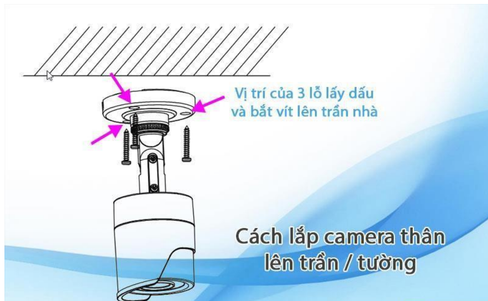
Hình 2.8 Cách lắp camera thân (bullet camera) cố định lên trần nhà / tường nhà
