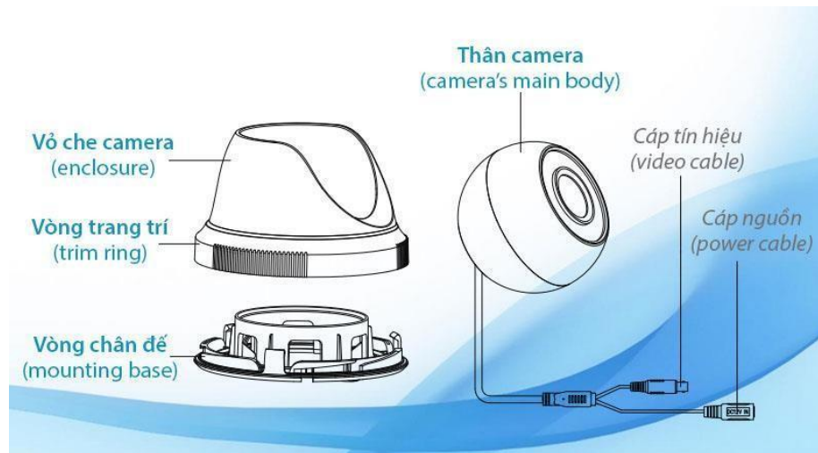
Hình 2.2 Kết cấu bên trong camera dome (dạng cầu).
