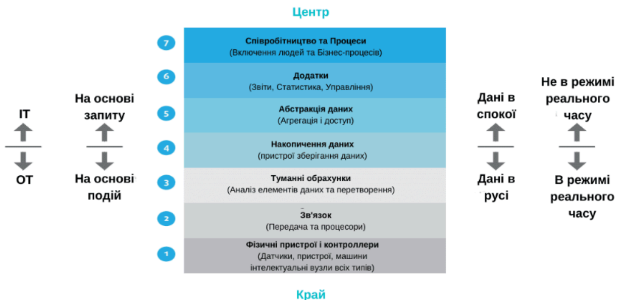
Рисунок 2.4 — Еталонна модель від Всесвітнього форуму IoT
