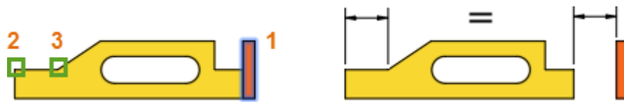
Рис. 2.71. Приклад використання методу двох точок
