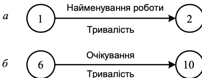
Рис. 39. Приклад позначення на сітковому графіку робіт, очікування, тривалості і коду робіт: а – код роботи (1, 2), б – код роботи (6, 10)
