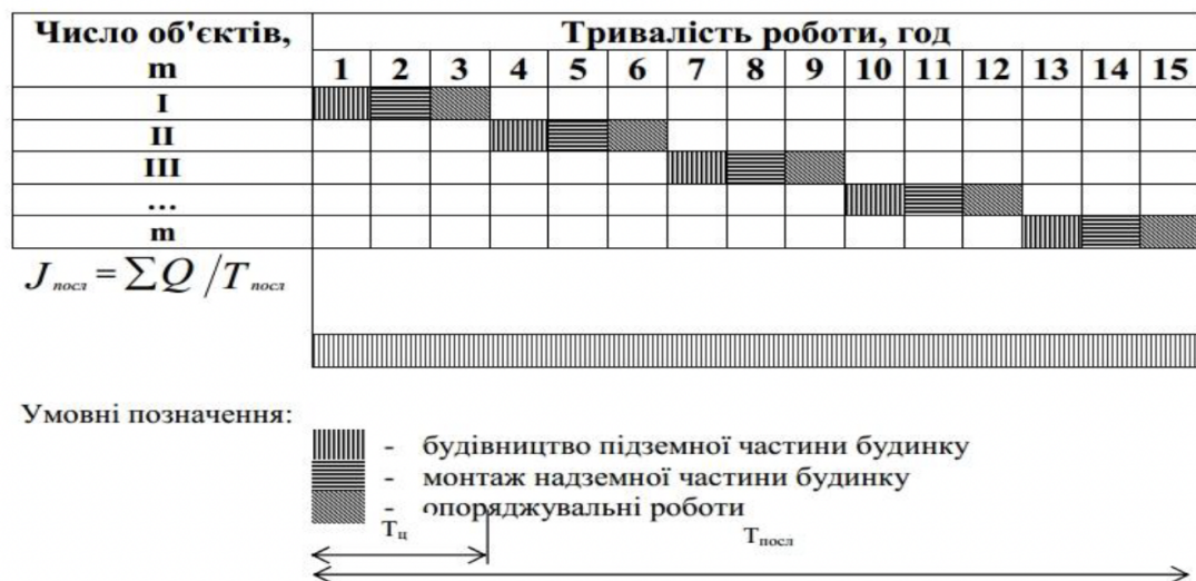
Рис. 16. Графік будівництва при використанні послідовного методу
