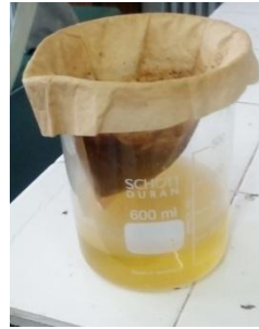
Figure 2. Mélanges récupéré et précipité lavé avec un mélange chloro./méth.(II)
