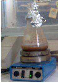
Figure 1. Mélange graine en poudre, chloroforme et éthanol sous agitation (I)
