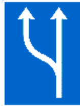
E16.1.7. Lane course progress
