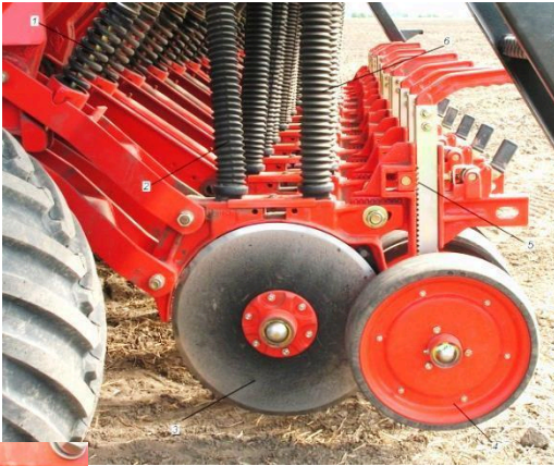
Рис. 40. Механізм регулювання швидкості обертання висівних катушок
