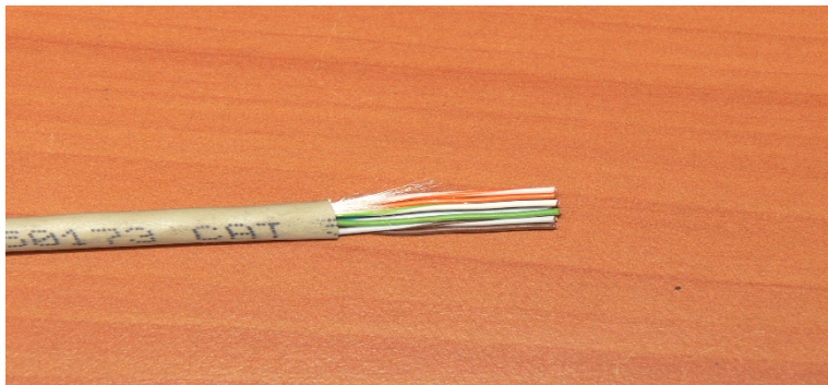
Рис. 4.7. Кабель «кручена пара» з розплетеними і випрямленими провідниками
