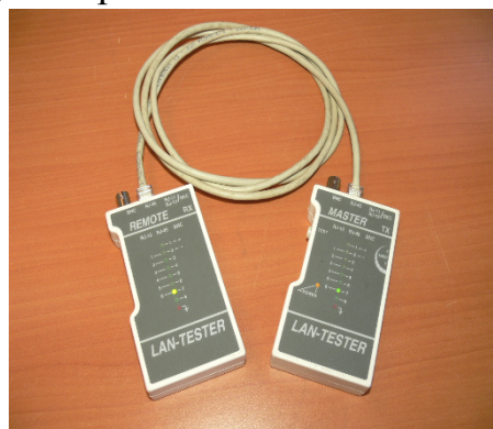
Рис. 4.10. Перевірка якості закладення конекторів RJ-45 за допомогою спеціального тестера
