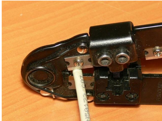
Рис. 4.6. Обрізка зовнішньої ізоляції на кабелі «кручена пара»
