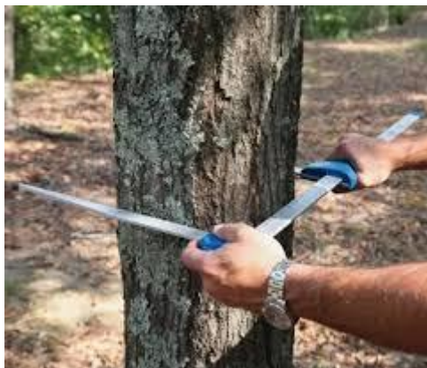
Figura1: Detalhe da medição do diâmetro das árvores.
