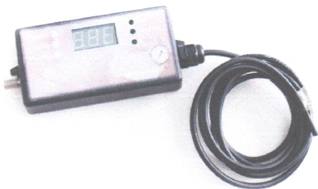
Рисунок 208. Прилад для контролю вакууму і параметрів його пульсацій доїльної установки.
