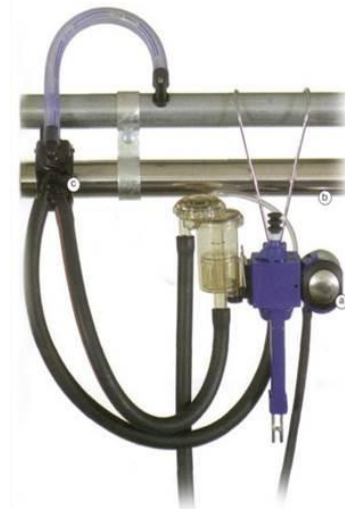
Рисунок 206. Загальна будова доїльного апарату MU210 з функцією «Дуовак» для доїння в молокопровід:
