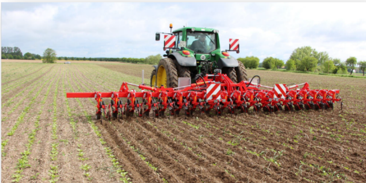
Рис. 3. Культиватор просапний, Einböck Chopstar , 18-рядковий (швидкість 8-12 км/год в залежності від розміру бур'яків)
