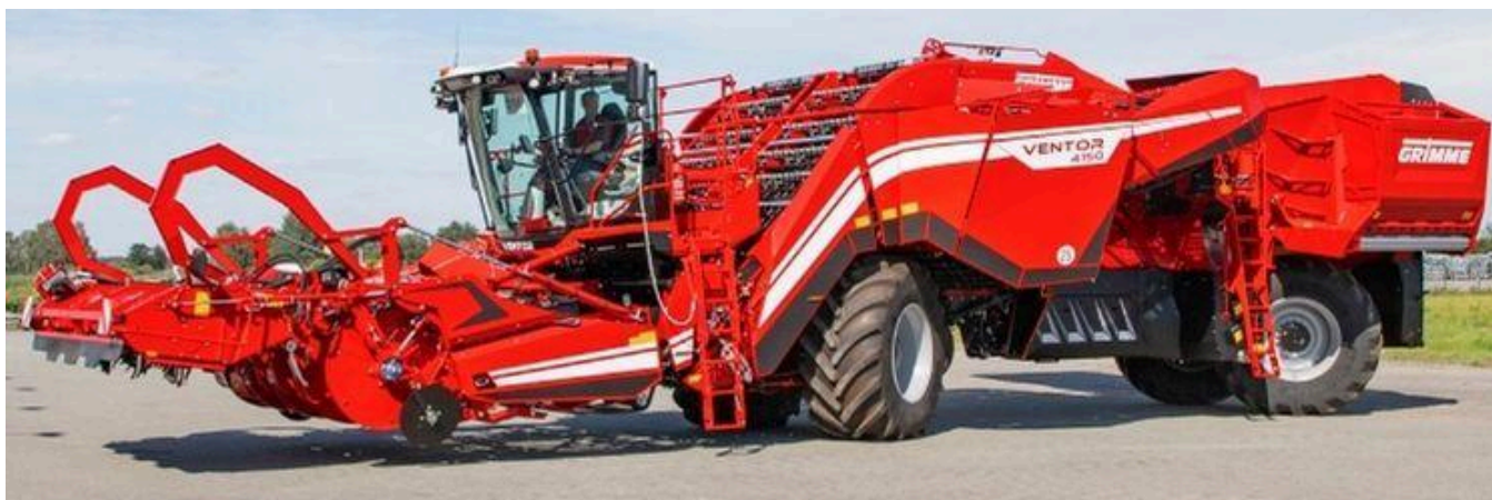
Рис.6. Самохідний 4-рядний картоплезбиральний комбайн Vektor 4150 (Grimme, Німеччина)
