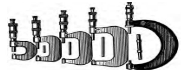
Рис. 2.50. Мікрометри типу МК
