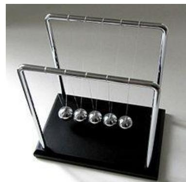
Die Anzahl der Kugeln und das Material können je nach Modell variieren. So entstehen fünf einzelne Pendel mit identischer Pendellänge und Masse. Da die Aufhängepunkte am Rahmen des Newtonpendels denselben Abstand besitzen wie der Kugeldurchmesser, hängen diese senkrecht in Ruhe.
