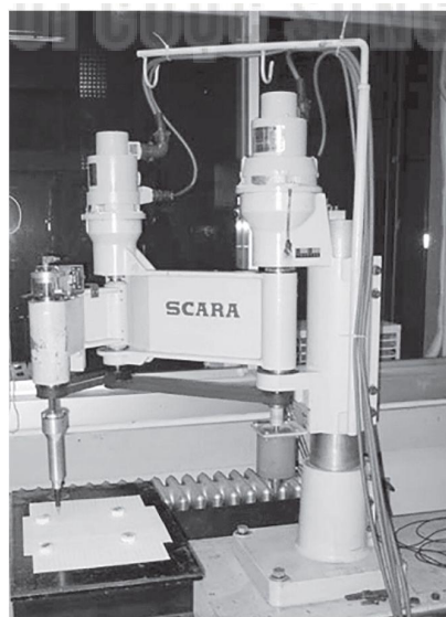
Hình 1.3. Robot SCARA đầu tiên phát minh bởi Hiroshi Makino năm 1978
