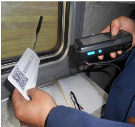
Рис. 6 Сканування коду електронного проїзного документа терміналом МТКД.
