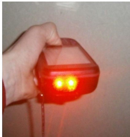
Рис. 6 Сканування коду електронного проїзного документа терміналом МТКД.
