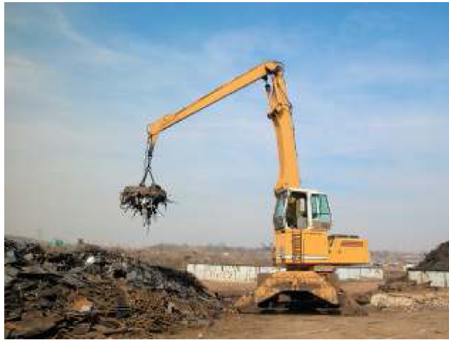
Gambar 5.29 Magnet digunakan untuk memisahkan benda mengandung besi dan baja dalam tumpukan sampah logam.
