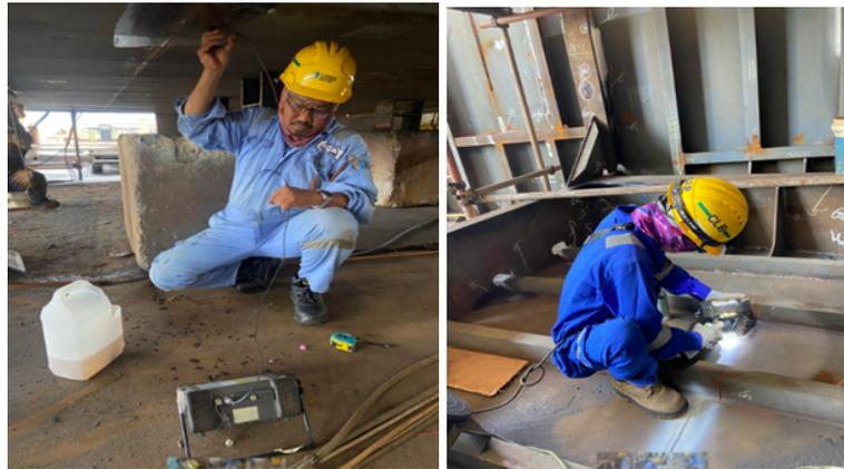
Gambar 4. 11 Seorang teknisi UT sebelah kiri dan teknisi MT/PT sebelah kanan sedang melakukan pengecheckan cacat pada area yang baru di repair
