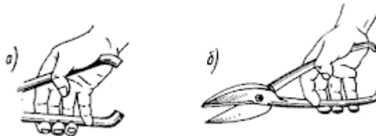
Мал. 5.26. Прийоми тримання («хватки») ножиць при різанні листового металу
