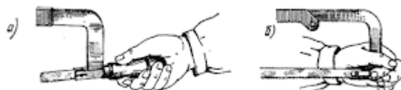
Мал. 5.14. «Хватка» ножівки: а – підготовчий прийом, б – виконавчий
