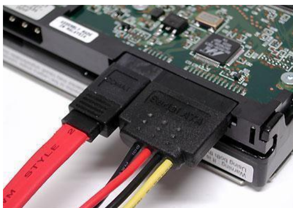
Рис. 9.21. Підключення SATA пристрою
