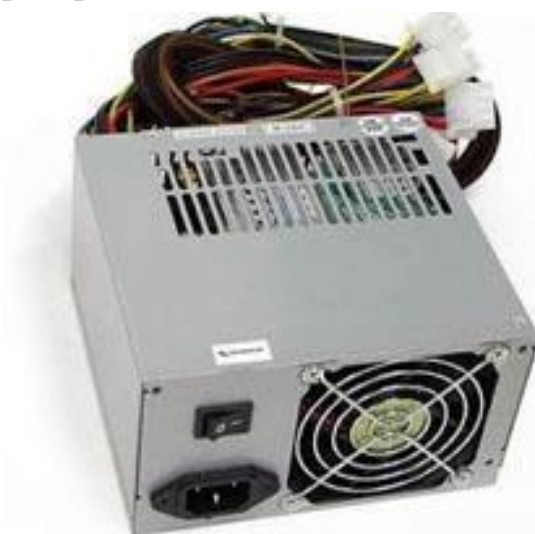
Рис. 8.5. Зовнішній вигляд блоку живлення ПК.
