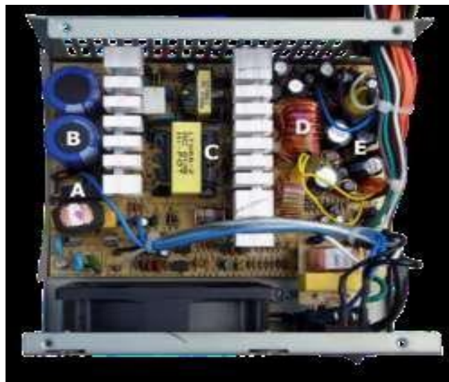
Рис. 8.6. Імпульсний блок живлення комп'ютера (ATX): А – вхідний діодний випрямляч, нижче видно вхідний дросельний фільтр; В – конденсатори вхідного фільтра, правіше – радіатор високовольтних транзисторів; С – імпульсний трансформатор, правіше видно радіатор низьковольтних діодних випрямлячів; D – дросель групової стабілізації; Е – конденсатори вихідного фільтра.
