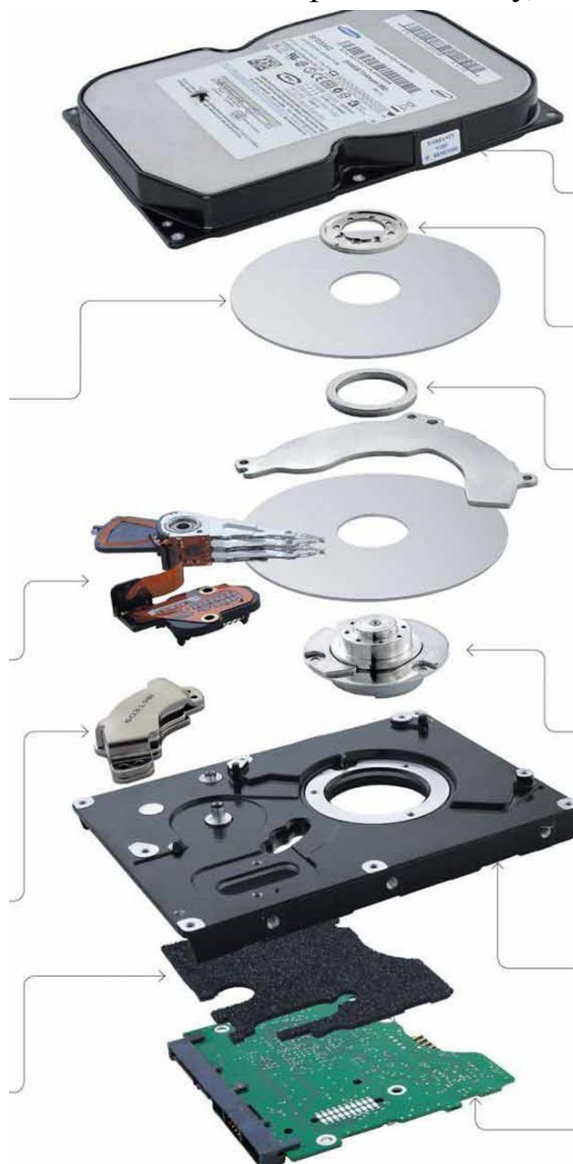
Рис. 9.22. Складові жорсткого диску
