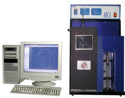
Рис. 5.3. Аналізатор фракційного складу нафти АФСА
