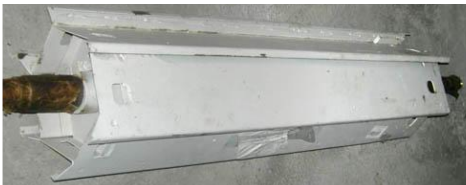
Рис. 13.4. Загальний вигляд відбійного бітера
