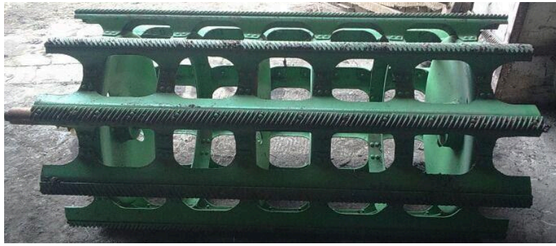
Рис. 13.2. Загальний вигляд молотильного апарата
