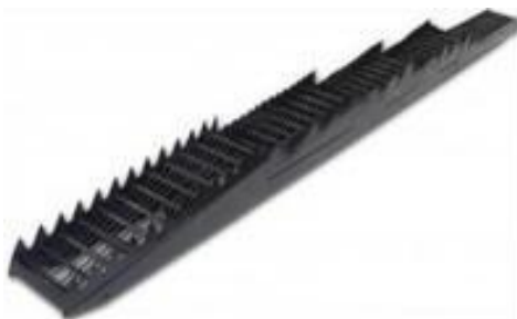
Рис. 13.5. Загальний вигляд клавiши соломотряса
