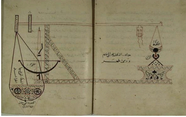
Karşı (Ters) Ağırlık Sistemiyle Çalışan Mancınık (Et-Tarsûsî)
