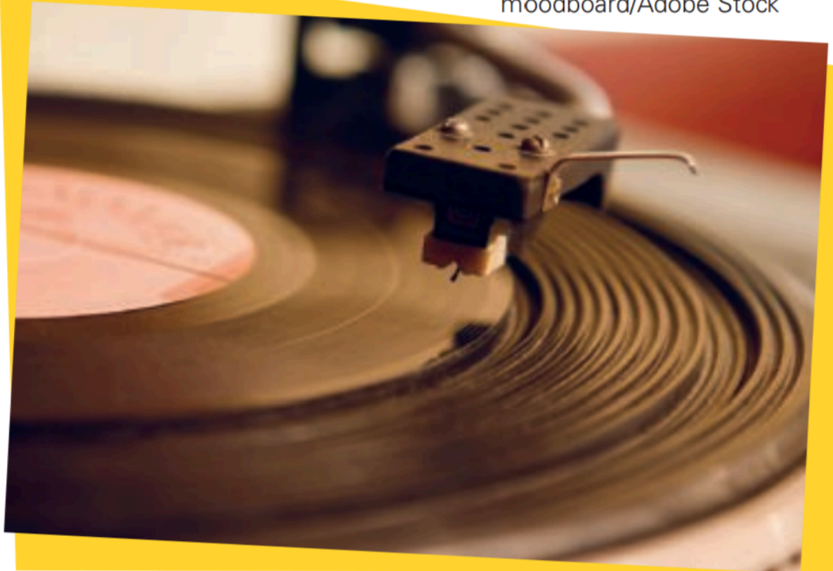
Figura: Detalhe de um disco de vinil no toca-discos. A agulha passa pelos sulcos do vinil para reproduzir a música. ( ALVAS, J.C. 17 )
