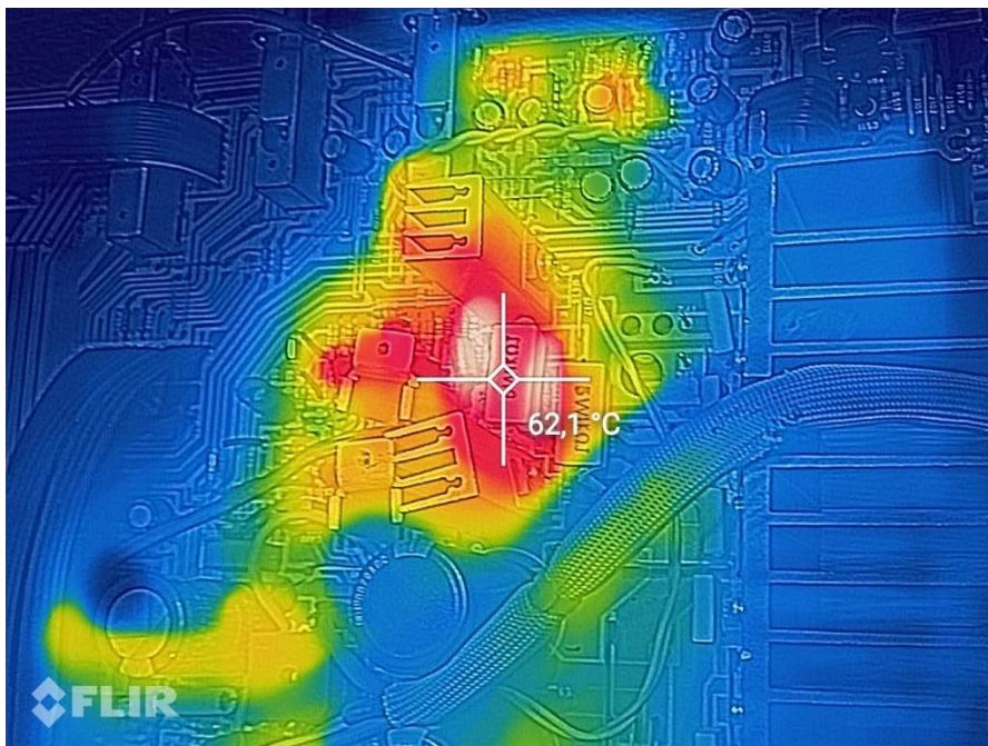
Widok grzejących się elementów pokazany przez kamerę termowizyjną
