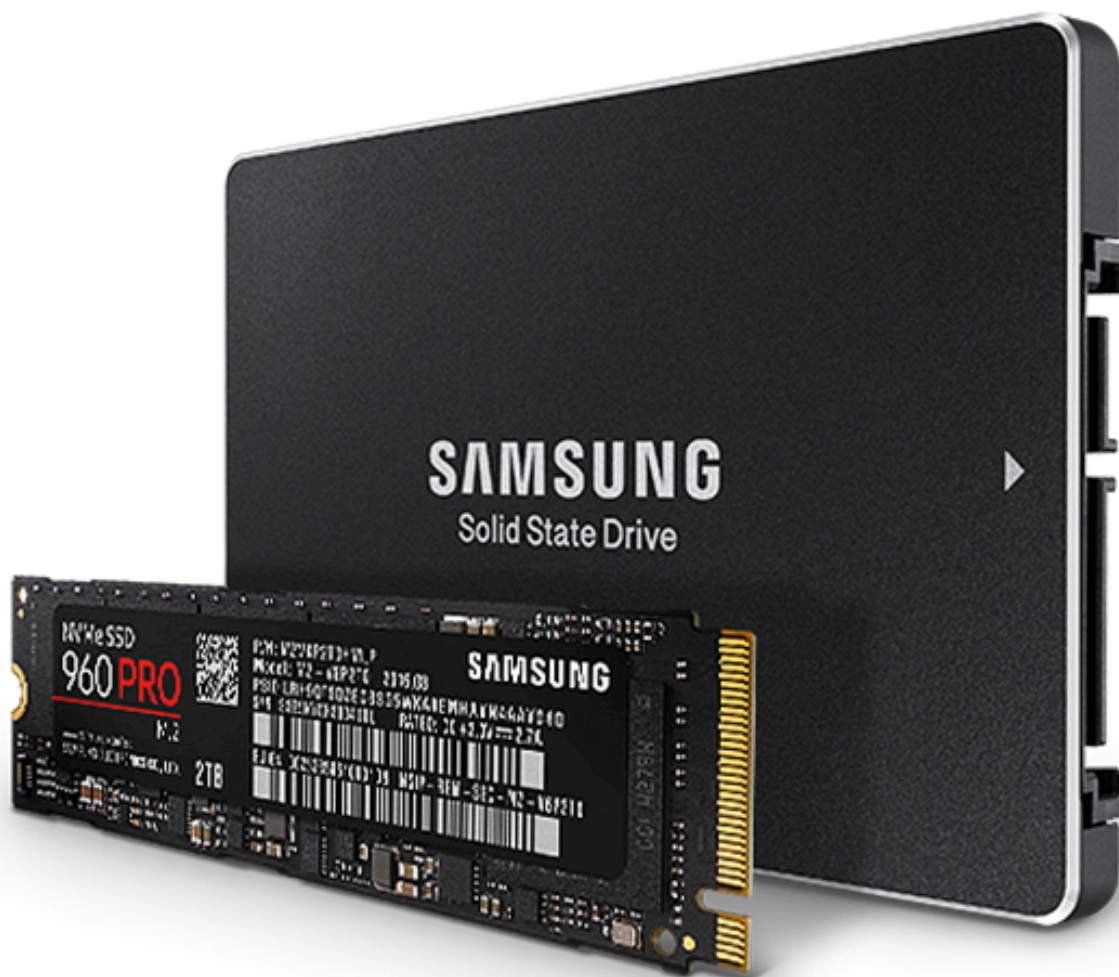
Dysk SSD 2,5" oraz dysk wykonany w technologii M2.
