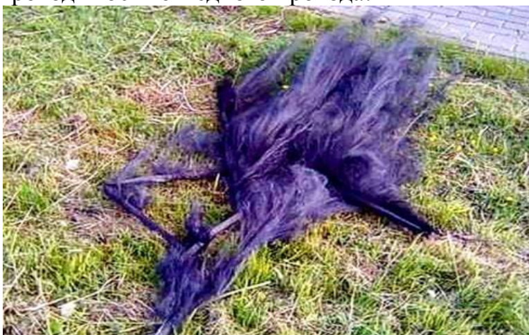
Углепластиковая удочка, после воздействия электрического тока.
