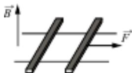
**C13.** По горизонтально расположенным шероховатым рельсам с пренебрежимо малым сопротивлением могут скользить два одинаковых стержня массой  $m = 100$  г и сопротивлением  $R = 0,1$  Ом каждый. Расстояние между рельсами  $l = 10$  см, а коэффициент трения между стержнями и рельсами  $\mu = 0,1$ . Рельсы со стержнями находятся в однородном вертикальном магнитном поле с индукцией  $B = 1$  Тл.
