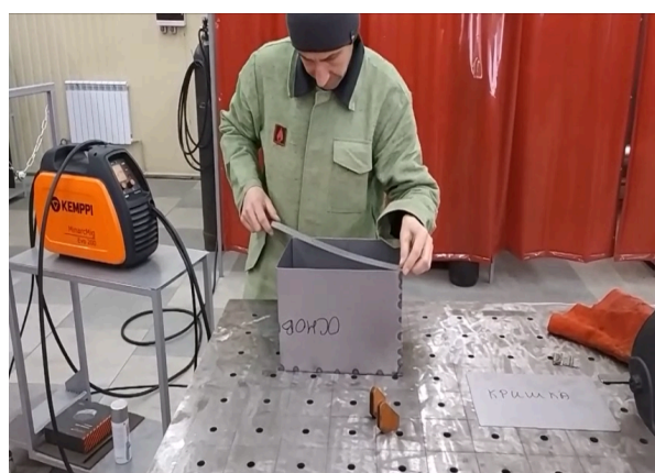
7. Перевірка діагоналі металевого ящика відповідно кресленню 360×360 мм
