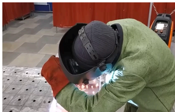
5. Зварювання корпусу металевого ящика
