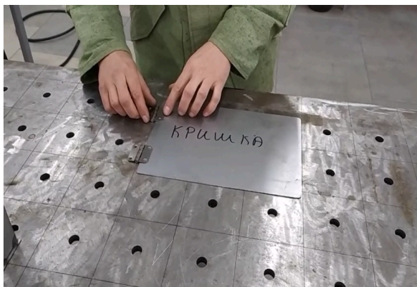
9. Встановлення та приварювання двох завісів на основу кришки ящика (заготовки)
