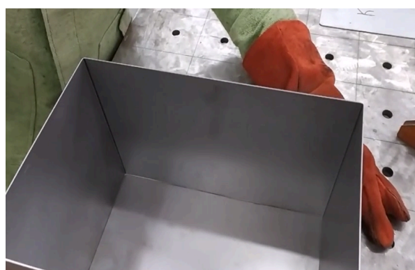
6. Встановлення та обварювання дна корпусу металевого ящика
