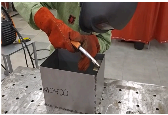
8. Встановлення кришки для прихвачування, приварювання упорної пластини 100×25×4 мм
