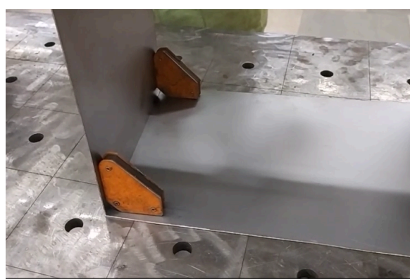
4. Встановлення магнітних кутників в заготовку для прихвачування
