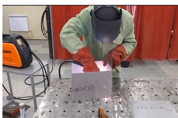
6. Встановлення та обварювання дна корпусу металевого ящика
