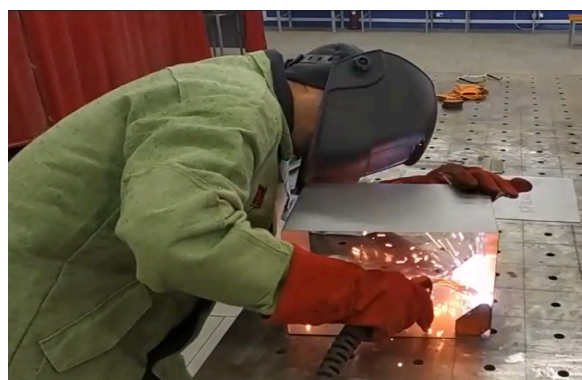
4. Встановлення магнітних кутників в заготовку для прихвачування
