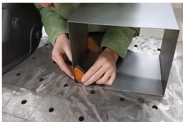
4. Встановлення магнітних кутників в заготовку для прихвачування
