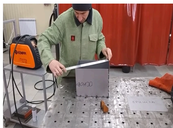
7. Перевірка діагоналі металевого ящика відповідно кресленню 360×360 мм
