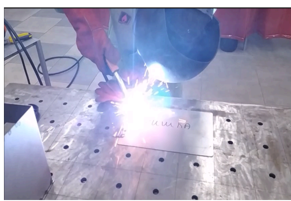
9. Встановлення та приварювання двох завісів на основу кришки ящика (заготовки)
