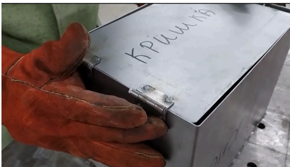
10. Встановлення та приварювання двох завісів кришки ящика (заготовки) на основу до ящика
