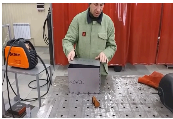
8. Встановлення кришки для прихвачування, приварювання упорної пластини 100×25×4 мм
