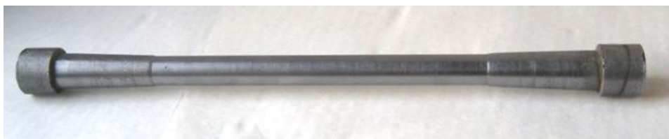
Рис. 1.1. Схема и фотография нормального образца
