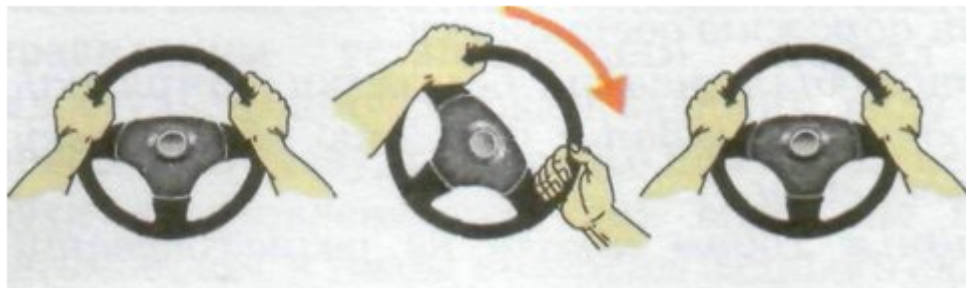
Рис.1. Положення рук на рульовому колесі при коригуючому керуванні
