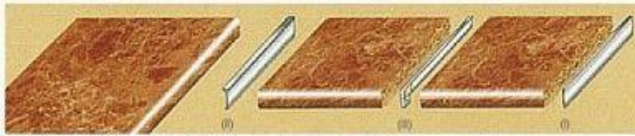
Схема крепления накладок на столешнице из лдсп
