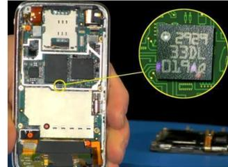
**-GIROSCOPIO:** El giroscopio es otro sensor que mide la aceleración no gravitacional, y que está destinado a complementar la información sobre la orientación del móvil que ofrece el acelerómetro. Para eso, añade una cuarta dimensión de movimiento que mide la rotación o el giro del móvil. Cuando alguna app te pide inclinar ligeramente la pantalla del móvil, es el giroscopio el que entra en acción para medir esos pequeños giros, ya que con ellos el acelerómetro no es suficiente.
