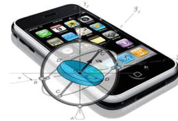
**-SENSOR DE HUELLA DACTILAR:** Contiene una serie de sensores capacitivos en una superficie sobre la que pones el dedo, y con la que el móvil es capaz de reconocer las líneas de nuestra huella dactilar y almacenar una imagen digital de estas. Entonces, cuando luego volvemos a poner el dedo encima el móvil puede comparar las líneas y saber si realmente somos nosotros o es otra persona.
