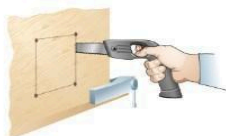
Рис. 4.44. Приём выпиливания внутреннего контура узкой выкружной ножовкой
