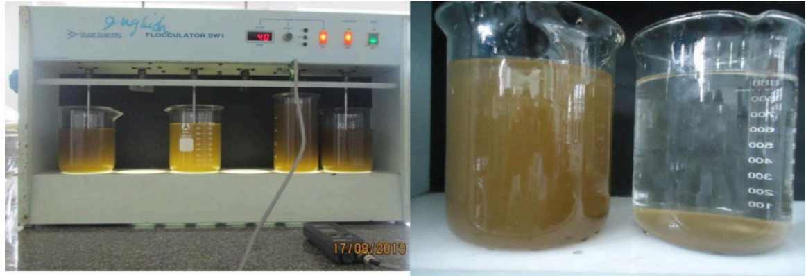
Hình 2.1. Bộ Jar-test để xác định liều lượng hóa chất tối ưu cho nước thải HLMT Hà Lâm
