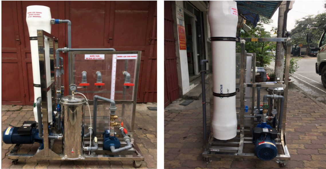
Hình 2.5. Mô hình thí nghiệm xử lý tái sử dụng nước thải HLMT mỏ than Hà Lâm đã qua xử lý bậc 1 đạt loại A QCVN 40:2011 để cấp nước cho sinh hoạt
