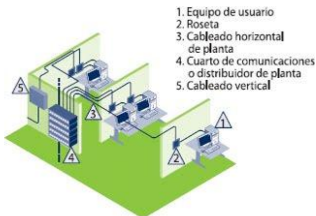
Figura 3.36. Cableado estructurado desde el cuarto de comunicaciones hasta el usuario final.
