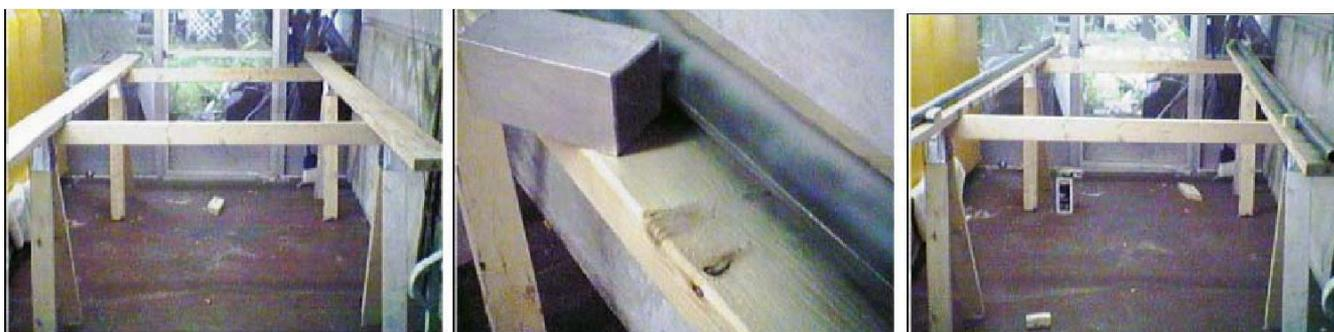
Найдите длинную, абсолютно плоскую доску и прикрепите трубу к ней. Не давайте трубе переместиться. Распылите тонкий слой Хромированного цинка вдоль стороны трубы. Положите обрезок квадратной трубы 50x50 против стороны трубы, и слегка поскребем краску квадратной трубой об круглую трубу. См. среднюю фотографию выше.
