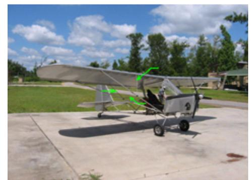
изготовить и прикрепить расчалки между основными подкосами из трубы Ø12x1.5 Они крепятся к основному подкосам хомутом с резиновыми накладками.
