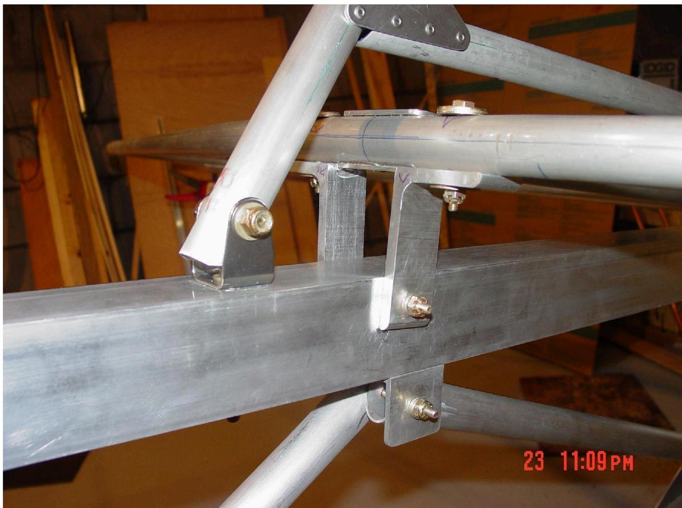
Изготовим поворотные коромысла из П-образного профиля 30x30x3мм. По одному для каждого элерона.
