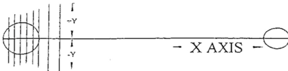
Профиль крыла представленный в трехмерной системе координат X,+Y, -Y приведен в таблице ниже. Первый столбец (X) -расстояние от передней кромки крыла вдоль хорды. Это число определяет точку на базовой линии (X), где нарисуем вертикальные линии.
