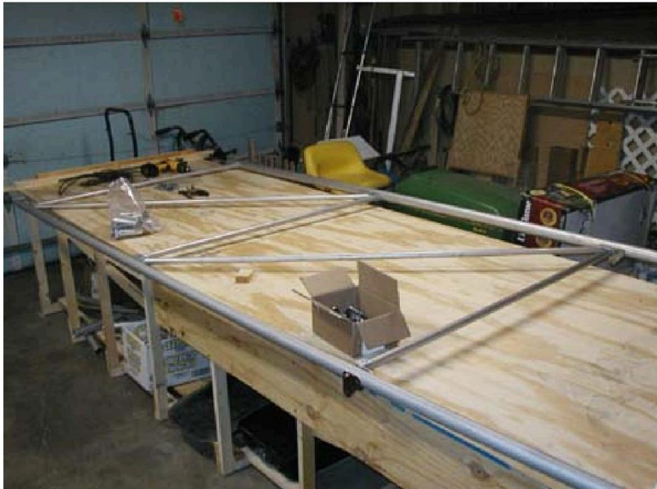
*Закрепим поперечные жесткости болтами к соответствующим скобам. Теперь займемся концами крыла. Они делаются так же как руль направления. Конец крыла сделаем из куска алюминиевой трубы 6061-T6 Ø25x1.5 изогнутой как на чертежах. Приклепаем их вытяжными заклепками из нержавеющей стали.*
