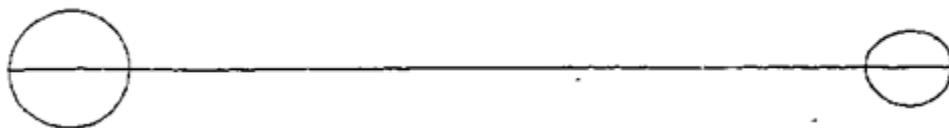
Шаг 2. Циркулем прочертим две окружности дюйма Ø50.8, по центру линии и Ø38.1 на другом конце линии. Как на картинке снизу:
