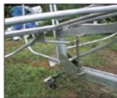
На фото вариант размещения рукоятки управления рулем высоты и элеронами по центру кабины. Это устраняет жесткую тягу (трубу) управления рулем высоты, как показано на чертежах. Это положение рукоятки более общепринято, и эта идея показана на фото.
