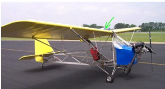
*Как только Ваш самолет готов, Вы должны пригласить лицензирующего инспектора FAA для осмотра самолета. Проверьте через каждый болт, труба и т.д. Заполните лист расчета центровки для него или ее. Запустите двигатель в положении для взлета и в горизонтальном положении.*
