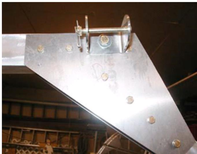
на 12.7мм” **выше** осевой (средней) линии квадратной трубы фюзеляжа, а заднее крепление является на 12.7мм **ниже** осевой (средней) линии. Это важно. Чтобы отверстия были точно друг с другом, я сверлил каждую стенку квадратной трубы отдельно, пока отверстия не встретятся в середине. Прделаем это для всех четырех точек навески крыла.
