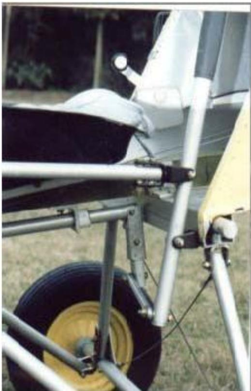
закрепим с двумя вытяжными заклепками Ø4.8.
